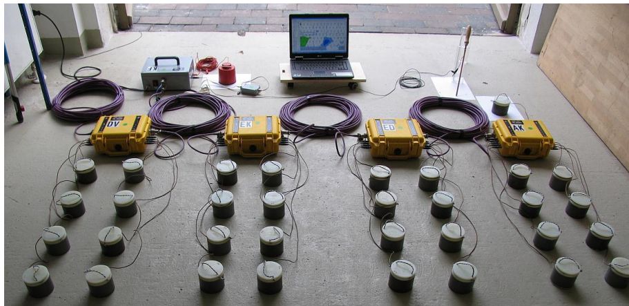
Foto: voorbeeld (semi)permanent meetsysteem.
