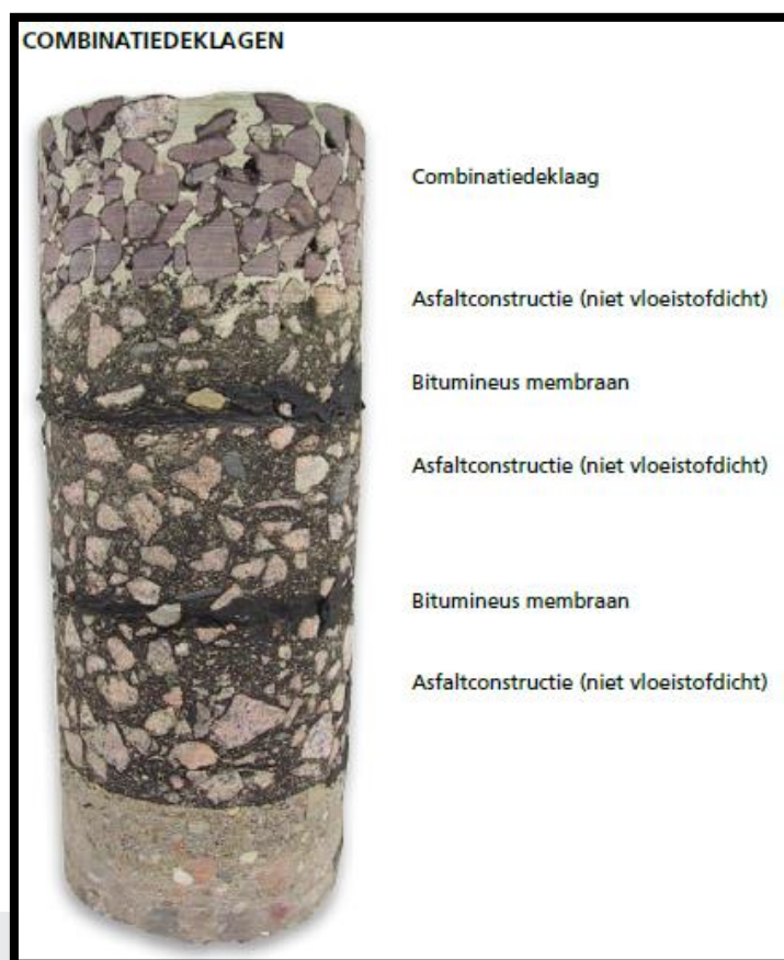
Foto: Voorbeeld van de opbouw van een combinatiedeklaag (bron: VBW Handleiding vloeistofdichte bitumineuze constructies).
