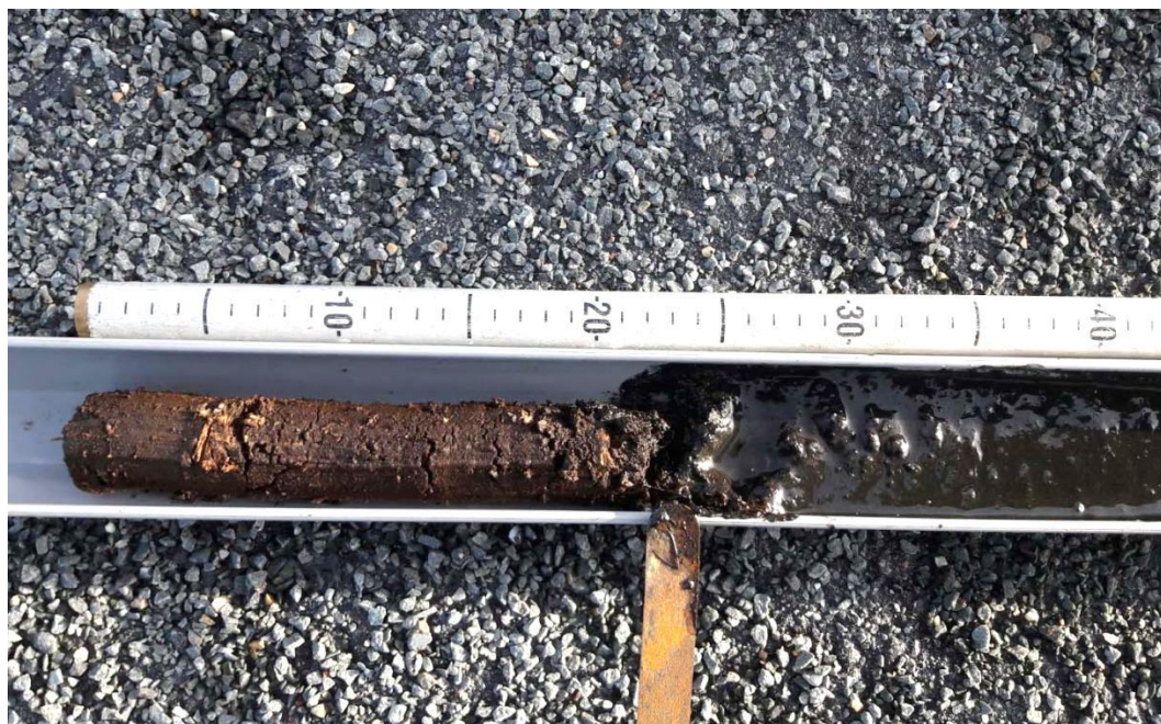
Afbeelding 5. Verificatiemeting onderzijde sedimentlaag / overgang naar vaste bodem
