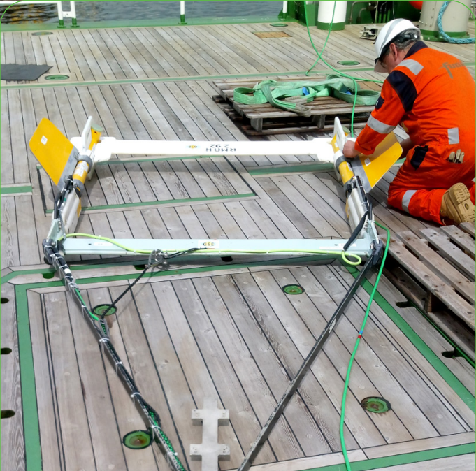
Magnetometer wordt geprepareerd voor gebruik onder water (Foto: T&A Survey)
