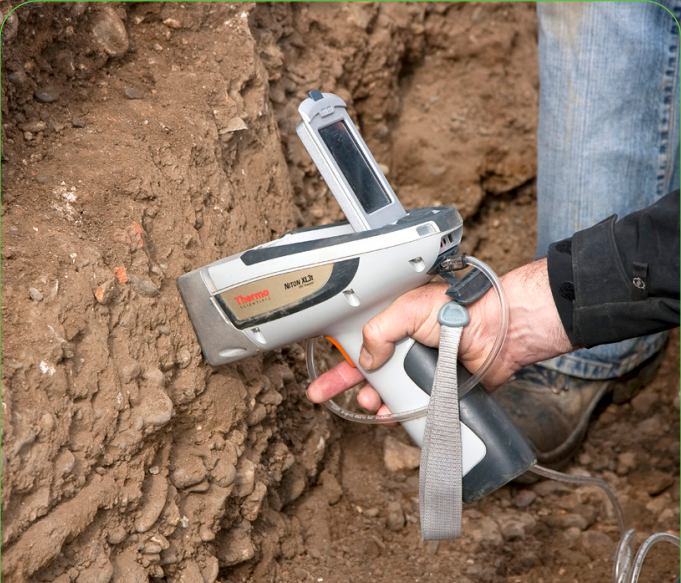
Meting met een XRF in het veld (Foto: RCE /Amersfoort/DG2009_1408)
