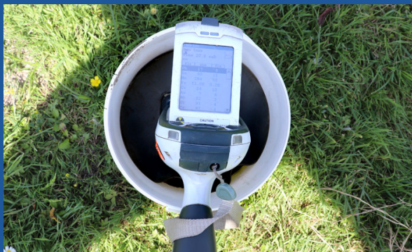
Uitlezing XRF in het veld (Foto: Van der Helm)
