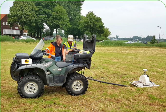
GPR in gebruik (Foto: Nancy de Jong-Lambregts)
