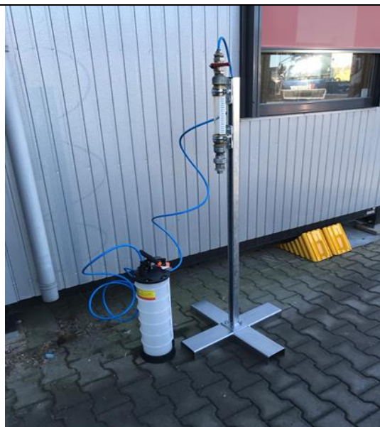
Foto 7.15.2.1: voorbeeld kijkglas met vacuümpomp
